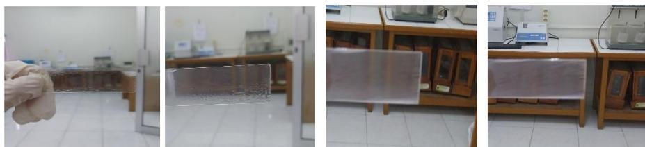
**Gambar 3.** Uji homogenitas ekstrak kering buah delima (*Punica granatum*)
