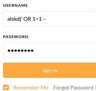
Gambar 4. Menguji Login Simpan dengan SQL Injection
